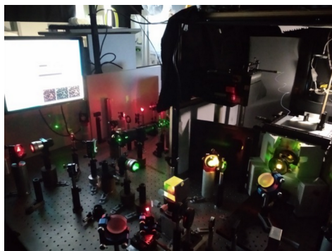
(Gauche) Montage expérimental TIRFM. (Droite) Schéma de principe d'auto-assemblage de protéines virales (en gris) éventuellement marquées sur un ARN viral greffé (en bleu).
